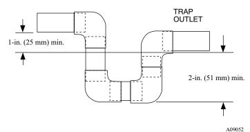
Fig. 7 – Condensate Trap
