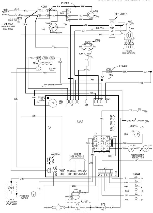
Fig. 14 – 208/230-1-60 Connection Wiring Diagram
