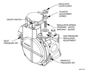
Fig. 13 – Single-Stage Gas Valve
