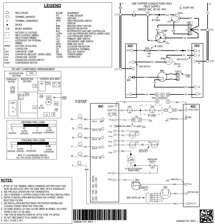
Fig. 15 - 208/230-1-60 Ladder Wiring Diagram
