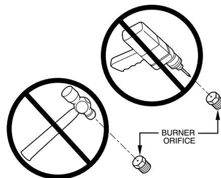
Fig. 64 – Orifice Hole
